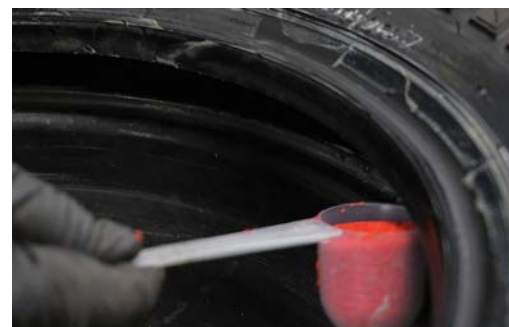
il misurino per inserire la giusta quantità delle microsferi nel pneumatico
