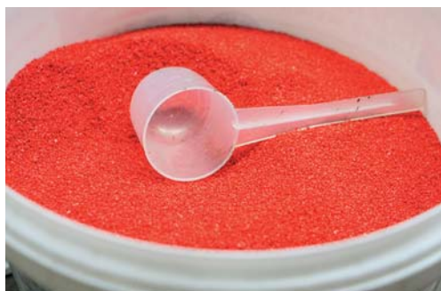
L'equilibratura è stata fatta usando 120 gr. di microsferi inserite nel pneumatico
